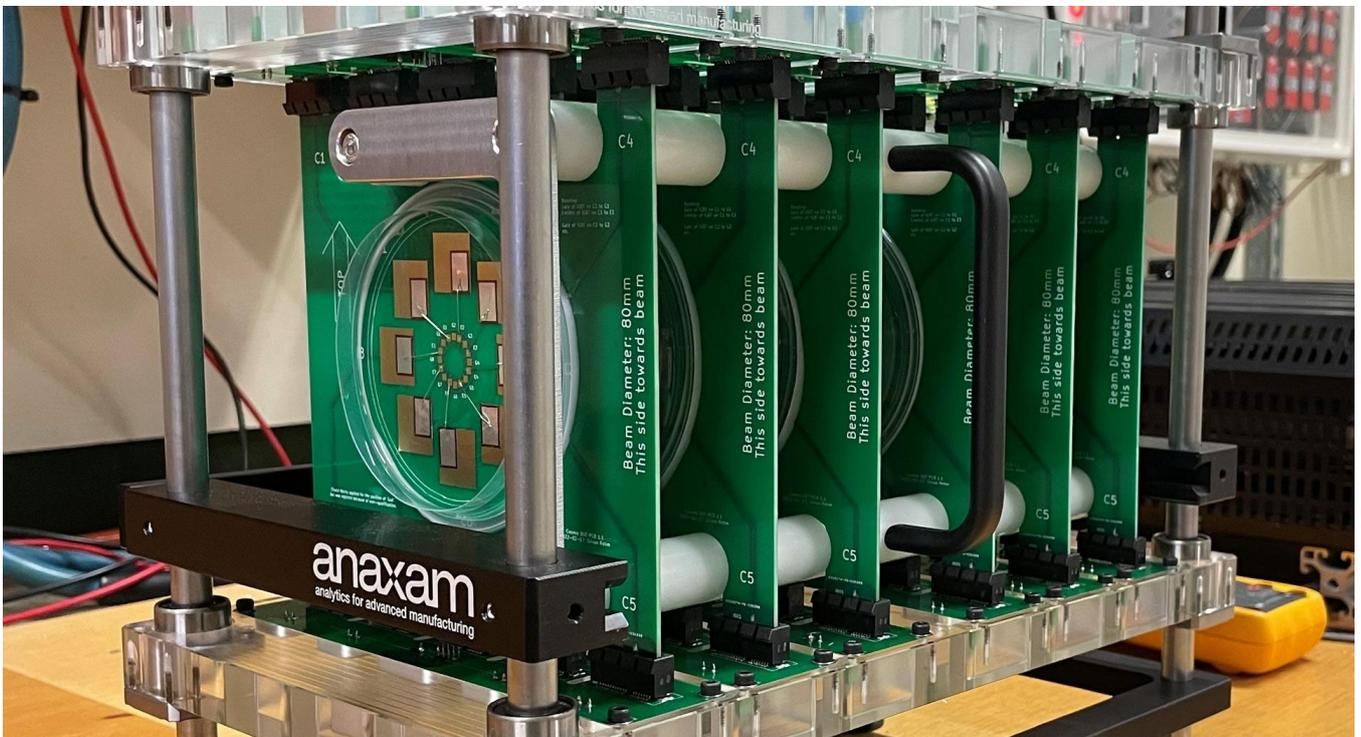
On étudie dans ce projet l'impact du rayonnement cosmique sur la fiabilité de couches d'oxyde de grille nanométriques dans des conditions électriques réalistes. Dans un dispositif de test spécialement développé à cet
