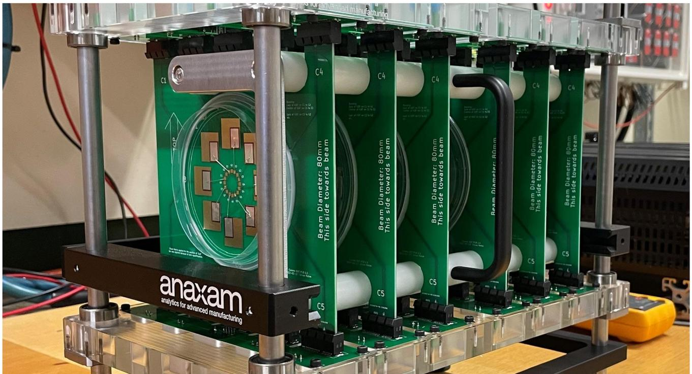
In diesem Projekt werden die Auswirkungen von kosmischer Strahlung auf die Zuverlässigkeit von nanoskaligen Gate-Oxid-Schichten unter realistischen elektrischen Bedingungen untersucht. In einem eigens entwickelten Testaufbau werden die von SwissSEM bereitgestellten Leistungshalbleiter einer Protonen- und Neutronenbestrahlung ausgesetzt, während eine Gate-Spannung
