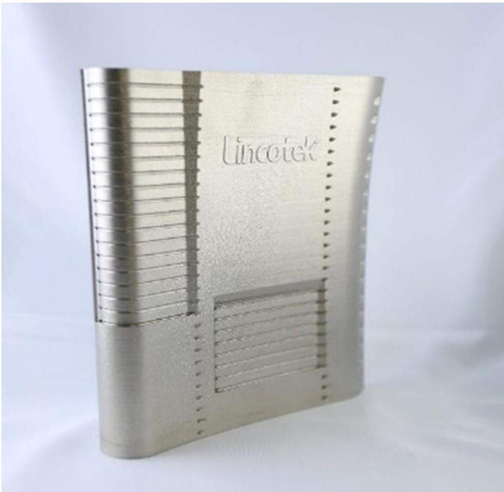
L'analyse appliquée des matériaux d'ANAXAM par diffraction neutronique aide Lincotek Additive à analyser les contraintes internes des superalliages à base de nickel après le
