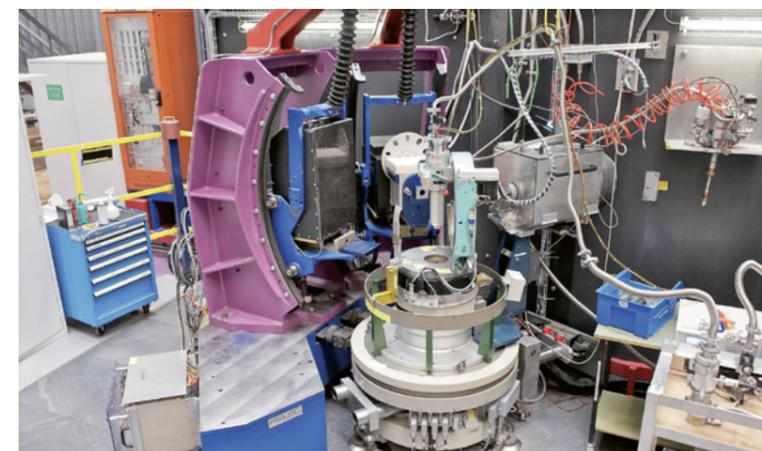
oben: Diffractionsinstrument am Synchrotron
